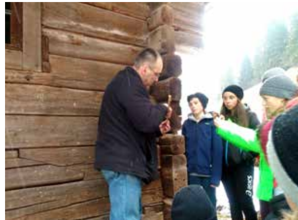
Entnahme eines Bohrkerns
